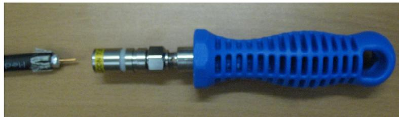
4. Остается обжать разъем специальным инструментом Cabelcon.
