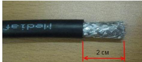
2. Далее расплести оплетку, загнуть поверх изоляции (A – 1 см). Затем отрезать внутреннюю изоляцию (B – 2.5 мм) и с помощью кусачек откусить центральную жилу до нужной величины (C – 11 м);
